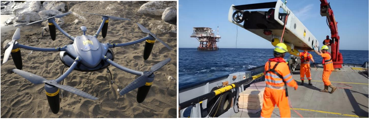
Fig. 2 – A sinistra, il drone anfibo brevettato e testato nell’ambito del progetto PLaCE ( https://bluegrowth-place.eu/?p=1480 ); a destra, il robot sottomarino Clean Sea per il monitoraggio ambientale e l’ispezione degli impianti offshore ( https://www.eni.com/it-IT/attivita/sottomarino-clean-sea.html )
